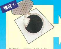
洗碗盆、浴缸的横水管 突出部位遮盖了开口处。
